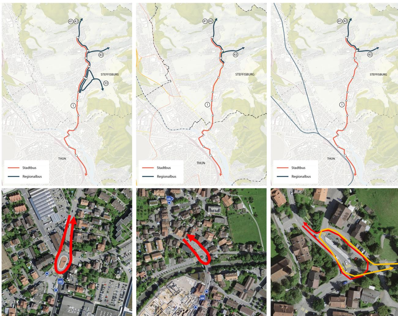
Variante 3a, Führung Regionallinien nur bis Kreisel Glockenthal. Dadurch kann die Haltestelle Ziegelei nicht bedient werden. Linie 33 macht Schlaufenfahrt
